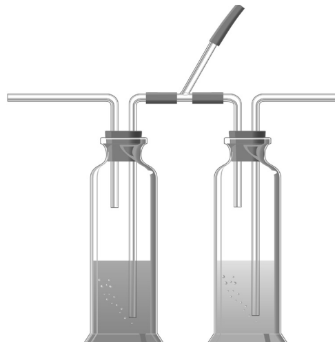
Versuchsaufbau zum Nachweis von \text{CO}_2 in der Atemluft
