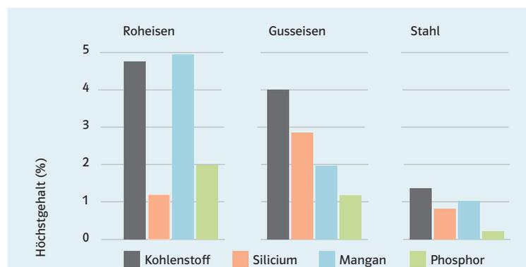
c) Berechne aus den Angaben in der Abbildung die Masse des Kohlenstoffs, die in einer Tonne Gusseisen enthalten sein kann.
