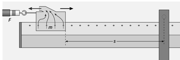
**V2** Ein Wagen mit der Masse  $m$  wird eine schiefe Ebene hinaufgezogen. Bei verschiedenen Steigungen werden die jeweils konstante, zum gleichförmigen Ziehen gerade benötigte Kraft  $F$ , die zurückgelegte Weglänge  $s$  und der Höhenunterschied  $h$  gemessen.
