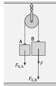
b) Durch die Kraft  $F = 9,81\text{N}$  wird ein Körper der Masse  $m = m_A + m_B = 3\text{kg}$  beschleunigt:
