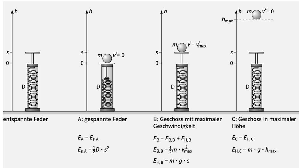
Unter der Annahme eines abgeschlossenen Systems (d.h. keine Energieumsetzung über die Systemgrenzen hinweg, z.B. infolge von Reibung) gilt:  $E_A = E_B = E_C$ . Ist die Spannweite  $s$  klein gegenüber der erreichten Flughöhe  $h_{\max}$ , so kann der Term  $E_{H,B}$  vernachlässigt werden und es gilt in guter Näherung:
