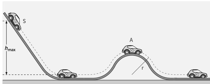
Ist die Starthöhe  $h$  größer als der Radius  $r$  der zu durchfahrenden Kreisbahn, dann besitzt der Wagen im Punkt A Höhenenergie  $E_{H,A}$  und Bewegungsenergie  $E_{B,A}$ ; er kann also den höchsten Punkt A durchfahren. Um auf einer Kreisbahn fahren zu können, muss auf den Wagen die Zentripetalkraft  $F_Z = \frac{m \cdot v^2}{r}$  wirken. Sie wird in diesem Fall durch die Gewichtskraft  $F_G = m \cdot g$  verursacht.
