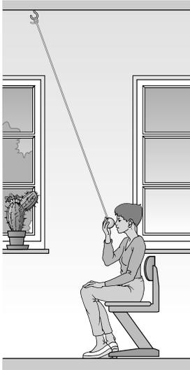
**V1** Ein Körper mit der Masse von etwa 1kg hängt an einer Schnur von der Zimmerdecke herab. Dieses Pendel wird bis zur Nasenspitze einer Versuchsperson ausgelenkt und dann losgelassen (siehe Abbildung links). Der Körper schwingt weg und kommt wieder zurück. Unmittelbar vor der Nasenspitze kehrt er um.
