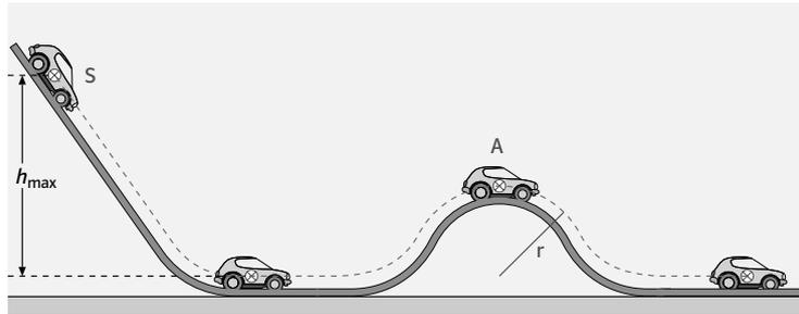
Ist die Starthöhe  $h$  größer als der Radius  $r$  der zu durchfahrenden Kreisbahn, dann besitzt der Wagen im Punkt A Höhenenergie  $E_{H,A}$  und Bewegungsenergie  $E_{B,A}$ ; er kann also den höchsten Punkt A durchfahren. Um auf einer Kreisbahn fahren zu können, muss auf den Wagen die Zentripetalkraft  $F_Z = \frac{m \cdot v^2}{r}$  wirken. Sie wird in diesem Fall durch die Gewichtskraft  $F_G = m \cdot g$  verursacht.
