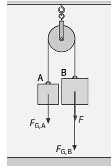
**b)** Durch die Kraft  $F = 9,81\text{ N}$  wird ein Körper der Masse  $m = m_A + m_B = 3\text{ kg}$  beschleunigt:
