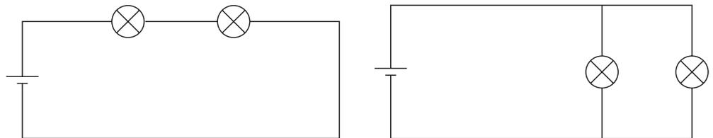
**b)** Wenn an der Quelle die Nennspannung 3V eingestellt wird, leuchten die Lampen in der Parallelschaltung hell, in der Reihenschaltung kaum oder gar nicht. Wird 6V eingestellt, so könnten die Lampen in der Parallelschaltung zerstört werden, in der Reihenschaltung leuchten sie hell.
