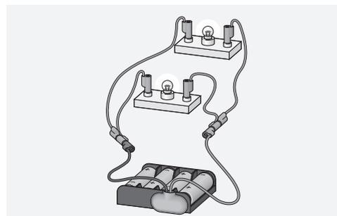
**V2** Schließe zunächst zwei, dann drei Lampen mit der Nennspannung 3V hintereinander an eine Quelle mit 6V. Bei der Schaltung mit zwei Lampen leuchtet jede heller als bei der Schaltung mit drei Lampen. Bei einer Quelle mit 9V leuchten auch die drei Lampen hell. Drehe eine Lampe aus der Fassung. Die anderen erlöschen ebenfalls.
