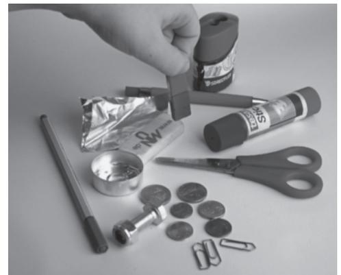
**V2** Hänge möglichst viele Nägel an die lange Seite eines Stabmagneten. Hänge an diese Nägel weitere Nägel. An den Enden des Stabmagneten kannst du mehr Nägel anbringen als in der Mitte.
