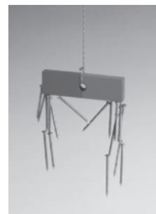
**V3** Teste mit verschiedenen Kühlschrankschrankmagneten, ob beide Seiten Gegenstände, die Eisen enthalten, anziehen. Viele Kühlschrankschrankmagnete ziehen Gegenstände aus Eisen nur auf einer Seite an.
