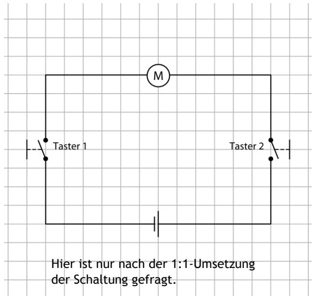
**A2** Benenne die Taster in der Schaltskizze mit Taster 1 und Taster 2. Ordne bei den folgenden Kärtchen durch Pfeile zu, ob sich der Motor dreht oder nicht.
