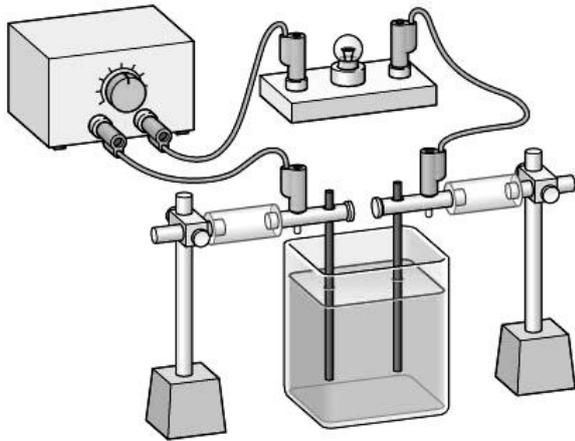
**Material:** Netzgerät, Kabel, Glühlampe, destilliertes Wasser, Salz, Becherglas, Graphitstäbe, Löffel
