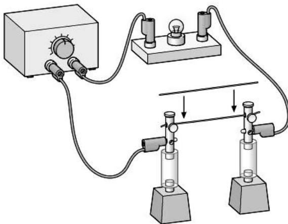
**Material:** Netzgerät, Kabel, Glühlampe, Eisendrähte, Isolatorstiele
